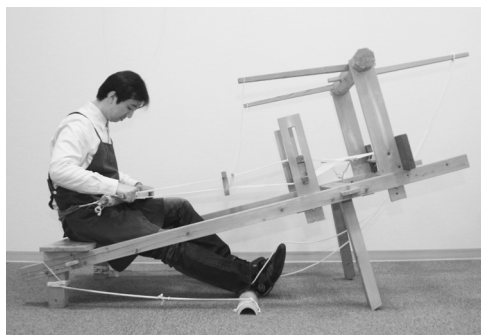
写真22 杼で横糸を締める
