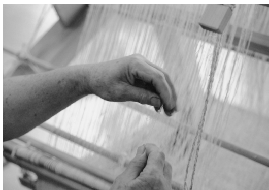
写真14 機結びで切れた経糸を繋ぐ
