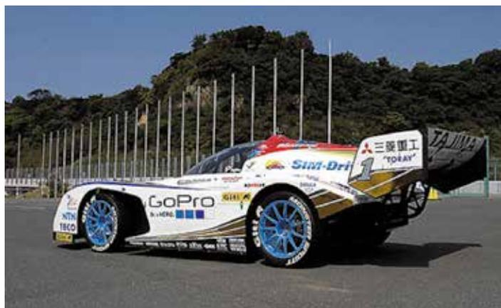
特徴的なデザインとしまして、かなり空力を意識しました。非常に空気抵抗を減らすということで、風洞実験を重ねることでつくった、特に後部が気流の乱れを減らすということで、最近のジェットエンジンの吹き出し口が同じような形状をしておりますけれども、空気の乱れを極限まで抑えようということで研究した結果、特徴的なリアビューになっております。
