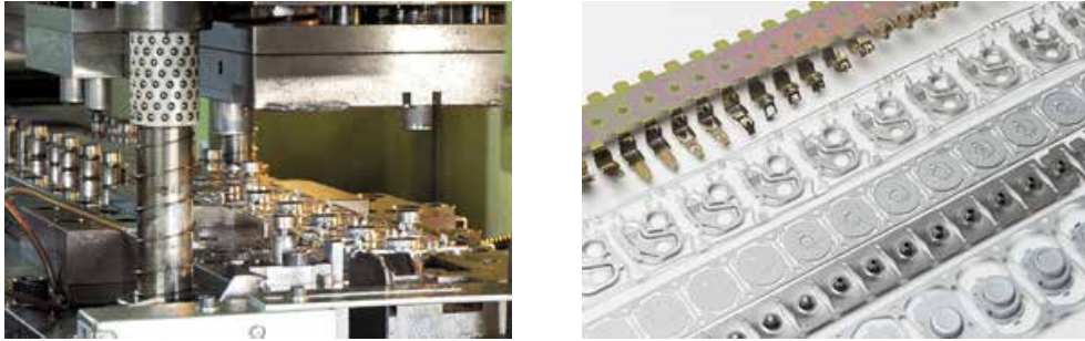
(注) 左側の写真は順送りプレス機と金型，右側がプレス部品の工程サンプル（スケルトン）。 (出所) 写真は伊藤製作所ホームページより許可を得て転載。
