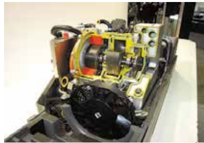
AUDI ロータリエンジン使ったレンジエクステンダEV
