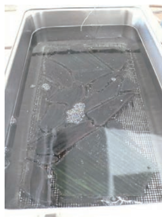
水洗液のひどい汚れ
