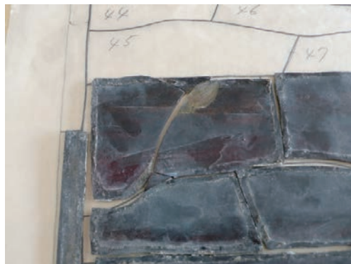
ガラスが割れた後、地震の揺れによつてのガラスの表面剥離
