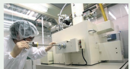
電子ビームリソグラフィ (研究棟に設置されている装置の一つ)
