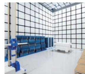
家電製品等から副次的に発生する微弱な電磁波は、他の電子機器の作動に影響を与える場合があります。これらの電磁波を正確に観測するための部屋。外からの電磁波を遮断し、さらに内部の壁面反射を抑えることで微弱な電磁波を正確に測定できます。
